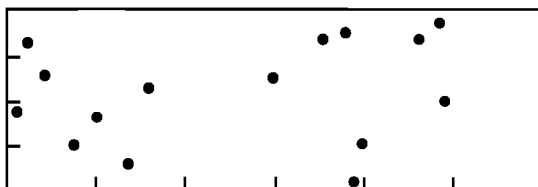
Рисунок А.1 — 1 процент поверхности, 15 пор, d = 1 мм
