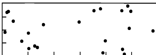
Рисунок А.2 — 1,5 процента поверхности, 23 поры, d = 1 мм
