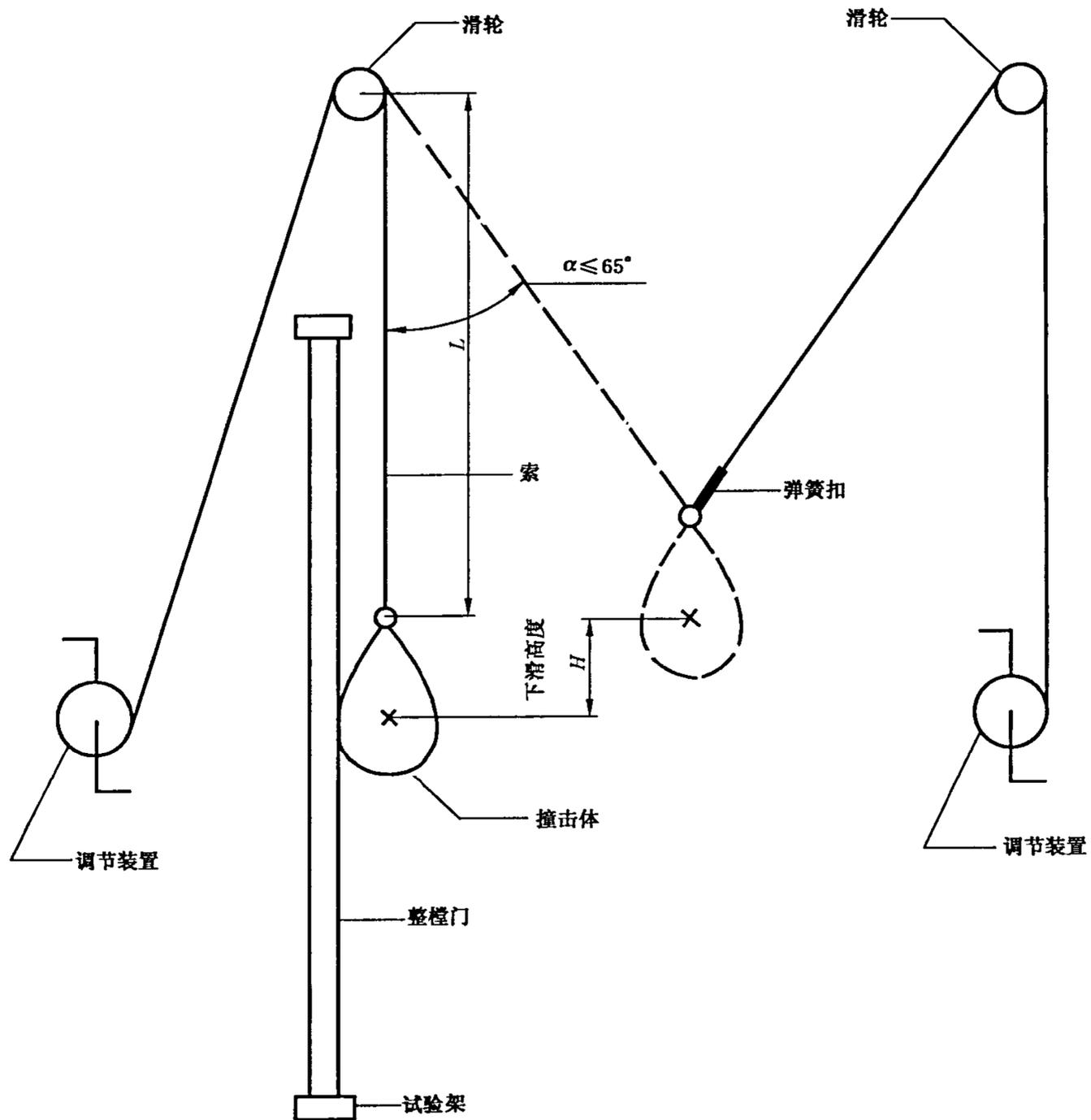
图 1 软重物体撞击试验装置和试验原理
