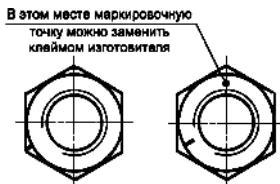
Рисунок 4 - Примеры маркировки кодовым символом (система циферблата)
